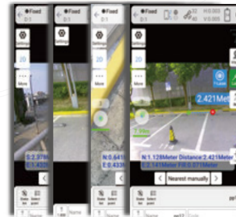
Levé et implantation visuels au laser
