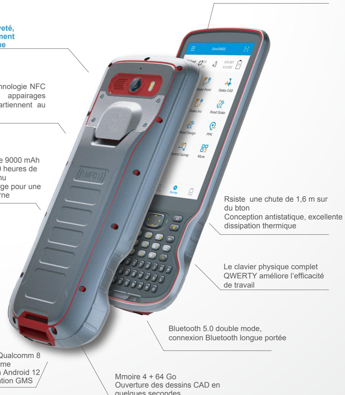
Processeur Qualcomm 8 coeurs, système d'exploitation Android 12 avec certification GMS
